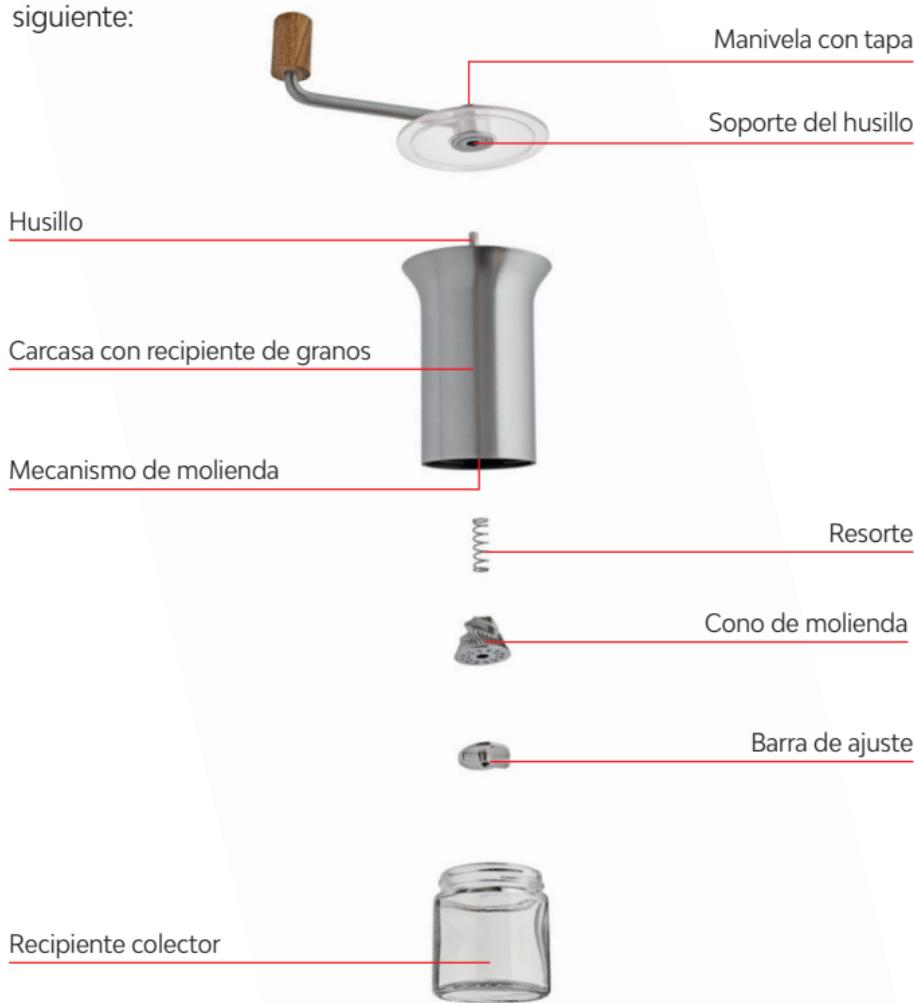
Desatornille el recipiente colector. Sujete la manivela con la tapa y dé la vuelta al molinillo. Gire la barra de ajuste en sentido contrario a las agujas del reloj hasta que se separe del molinillo y retírela. Retire el cono de molienda y el resorte.
